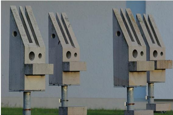
**Die Gesteinskörper aus den 1980er Jahren werden regelmäßig vom Fraunhofer IBP u.a. per Ultraschall untersucht.**
