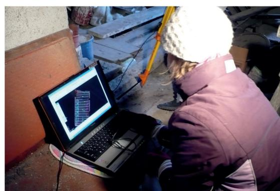
Über ein Datenkabel wird die Verbindung vom Tachymeter zum Notebook hergestellt, auf dessen Bildschirm die einzelnen gemessenen Punkte erscheinen und schließlich eine zusammenhängende Zeichnung ergeben.
