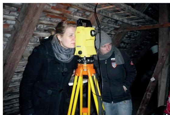
Ausgehend von diesem unabhängigen System werden alle bauwerkbeschreibenden Punkte mit einem Laserstrahl anvisiert und deren Koordinaten Punkt für Punkt gemessen.
