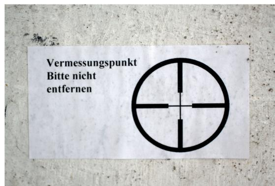
Vermessungspunkte werden als unabhängiges Messsystem an verschiedenen Stellen im Raum angebracht.
