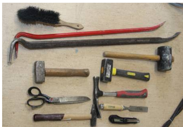
Bild 26: Eingesetztes Werkzeug für den Rückbau des Innendämmsystems.
