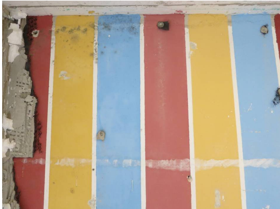
Bild 35: Detailfeld 3 auf der Ostseite mit dem Bindemittelsystem Emulsion und Abdichtungsebene 4 "CCD". Es sind geringe mechanische Schäden vorhanden.
