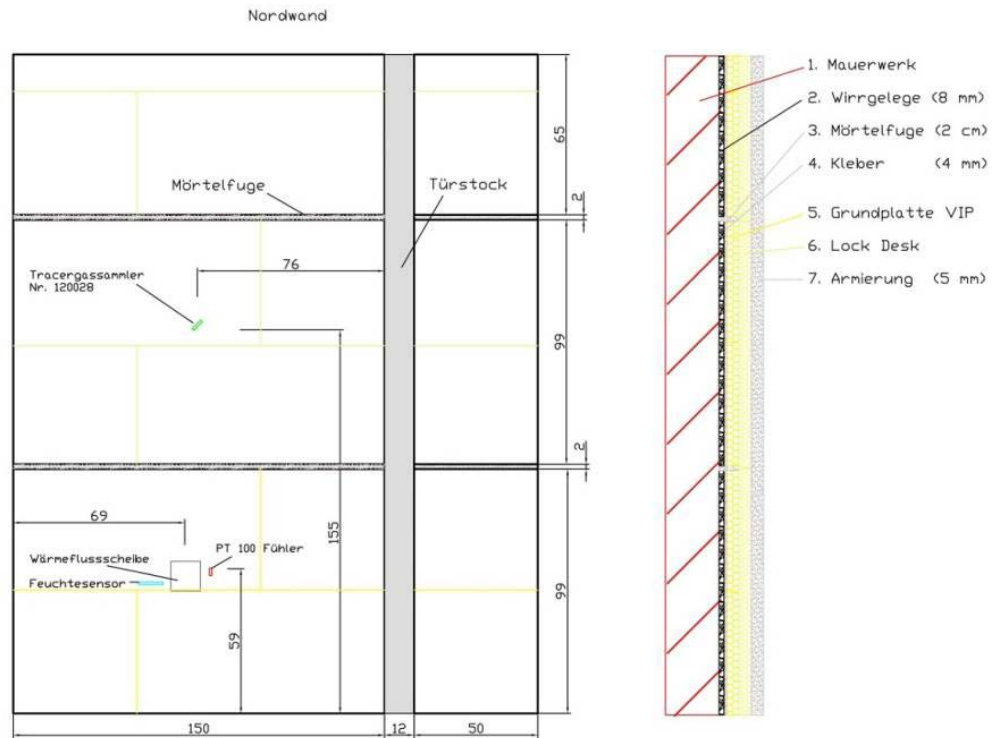
Bild 13: Ansicht Wand Nord mit Messaufbau und Abdichtungsebenen.
