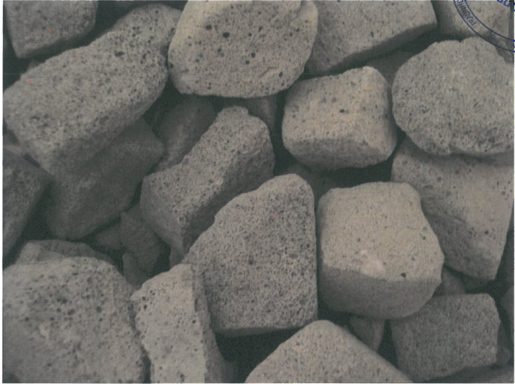
Bild 15: Detailansicht des eingebauten Glasschaumgranulates.
