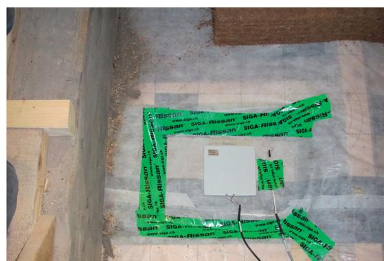
In die Dämmfelder der Geschossdecke wurden jeweils Sensoren für Temperatur, relative Feuchte und Wärmestrom verlegt. An ausgewählten Positionen wurde die Dämmung nochmals entfernt und nach dem Einsetzen der Sensoren wieder fachgerecht eingelegt und verschlossen.
