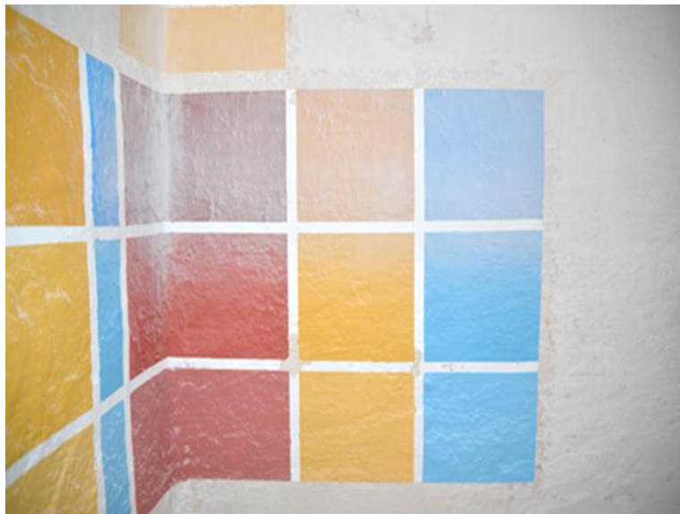
Bild 166: Farbmatrizes während Auftrag des Cyclododecans.
