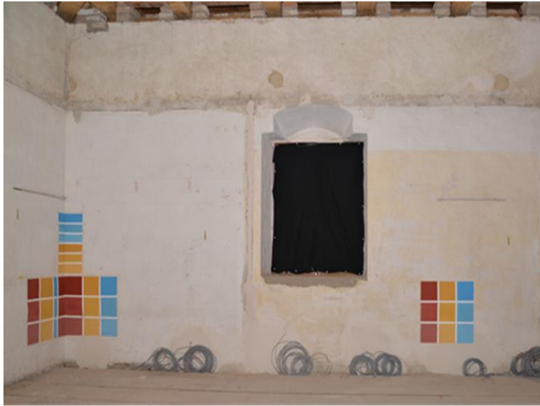
Bild 57: Wandansicht mit Testfarbfelder zur Überprüfung der Reversibilität an Feld 12 und 13 und erster Sensorik, Aufnahme am 16.09.2013.
