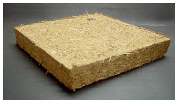
Als Platte verpresst, eignet sich Typha für nahezu jede Dämmanwendung. Ob als Zwischensparrendämmung im Dachbereich oder als verputzbare Innen- bzw. Außendämmung ist diese Platte vielseitig einsetzbar.
